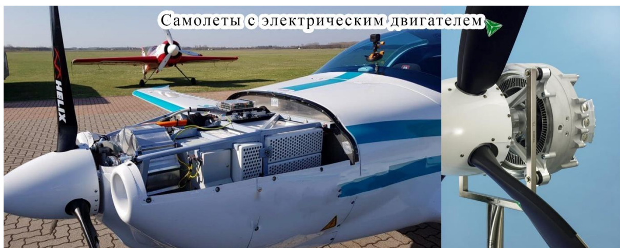
Самолеты с электрическим двигателем. Справа - электродвигатель
