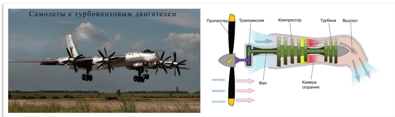
Самолет Ту-95 с 4-мя турбовинтовыми двигателями. Справа – схема устройства ТВД
